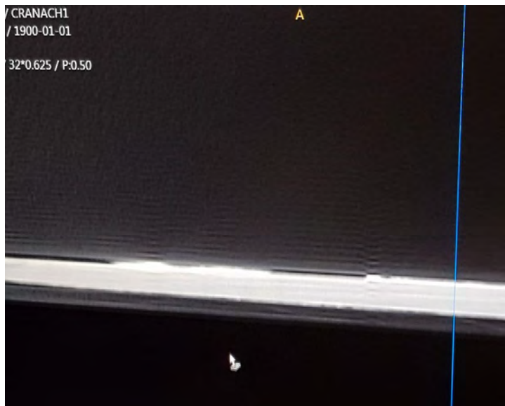
il. 7 Lucas Cranach starszy, Adam i Ewa , Muzeum Narodowe w Warszawie, fragment w obrazowaniu w tomografii komputerowej; widoczna różnica w absorpcji promieniowania rentgenowskiego w partiach postaci, zawierających ołów (jasne, grubsze warstwy) od partii czarnego tła, gdzie ołów występuje tylko w podkładzie fot. Łukasz Kownacki
