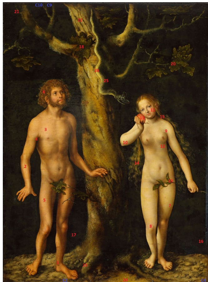
il. 9 Lucas Cranach starszy, Adam i Ewa , Muzeum Narodowe w Warszawie, mapka punktów pomiaru FTIR (nr 1-26) i mikropróbek do badań GC/MS i LC/MS (nr C2, C4, C9, C10) fot. Magdalena Wróbel-Szypuła
